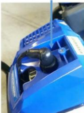
Sejměte zapalovací kabel
